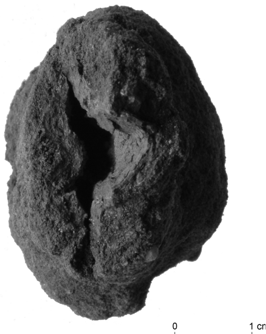
Fig. 25.4. Dwarsdoorsnede van een ijzeren speer- of lanspunt met de kenmerken van corrosie uit gemiddeld zuurstofrijke bodemomstandigheden. Dit voorwerp (vondstnr. 193, LCM 01050) is illustratief voor de kwalificatie FE 4. Er is geen metaal meer aanwezig en de kern is hol (foto G.J.M. van Oortmerssen, LCM/GIA).
