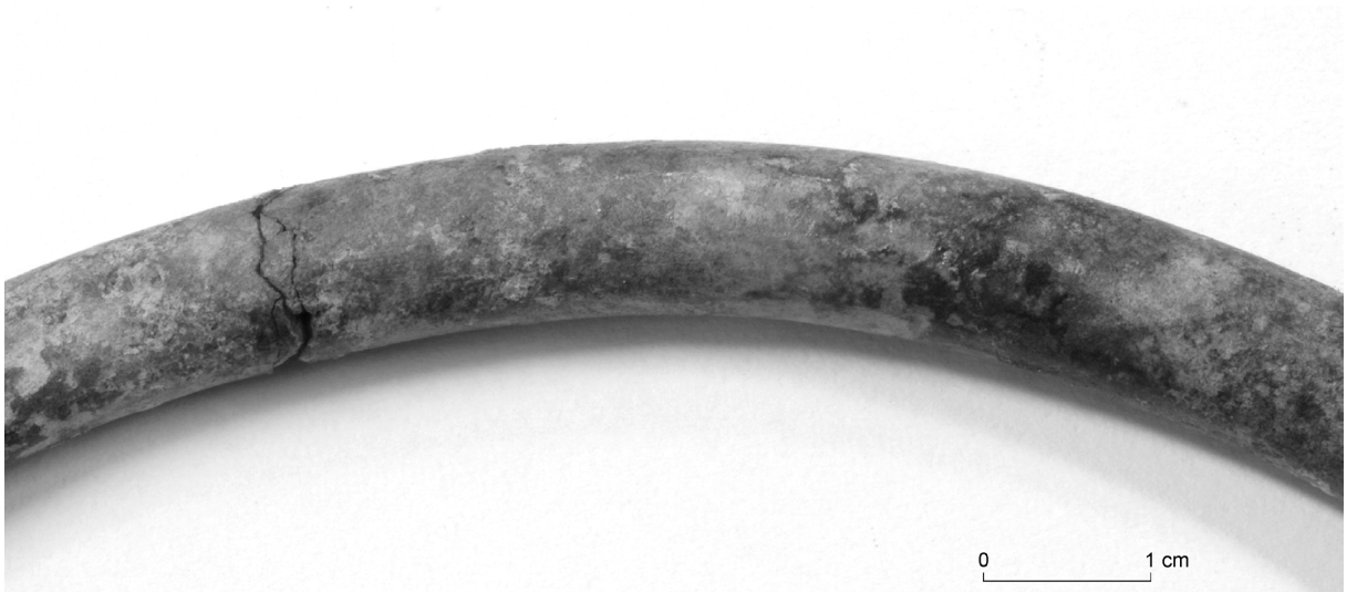
Fig. 25.6a. Twee gereconstrueerde fragmenten van de koperen armring uit graf 3 als voorbeeld van corrosievorming tot stabiele producten met behoud van origineel oppervlak (foto G.J.M. van Oortmerssen, LCM/GIA).
