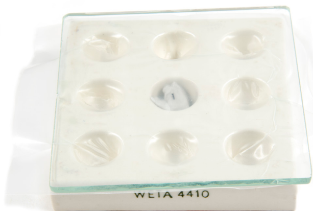
Fig. 10a. Testopstelling voor het uitdampen van één met PEG 4000 in DCM geïmpregneerd aarspilfragment. De lengte van één aarspilsegment (zie fig. 2) is ongeveer 4 mm. (foto: auteur).
