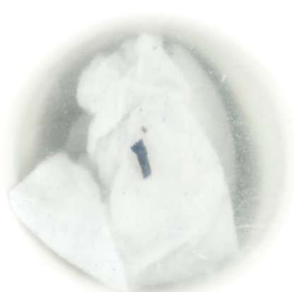
Fig. 10b. Testopstelling voor het uitdampen van één met PEG 4000 in DCM geïmpregneerd aarspilfragment (detail). De lengte van één aarspilsegment (zie fig. 2) is ongeveer 4 mm. (foto: auteur).
