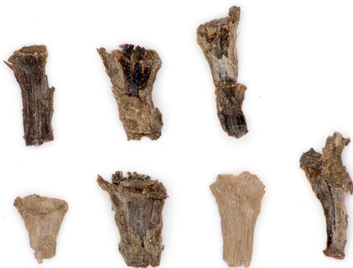
Fig. 12b. Methode G: conditie van de aarspilfragmenten na ontwatering in aceton, impregnatie met PEG 6000 in DCM en drogen aan lucht bij kamertemperatuur. De lengte van één aarspilsegment (zie fig. 2) is ongeveer 4 mm. (foto: auteur).
