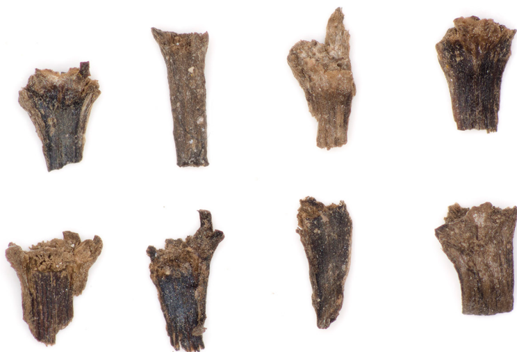
Fig. 13b. Methode H: conditie van de aarspilfragmenten na ontwatering in aceton, impregnatie met PEG 600/4000 in DCM en drogen aan lucht bij kamertemperatuur. De lengte van één aarspilsegment (zie fig. 2) is ongeveer 4 mm. (foto: auteur).
